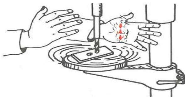
2.44. ábra. A helytelen munkadarab-befogás következménye oszlopos fúrógépen
